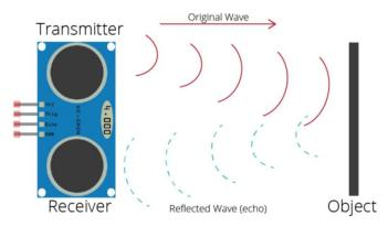
Fig. 3Ultrasonic sensor HC-SR04
